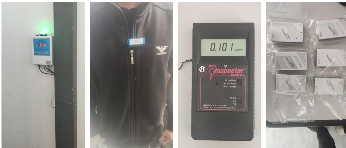
图4-10 固定式辐射监测仪、个人剂量计、辐射巡测仪及个人剂量报警仪
